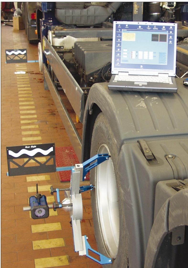
Die Kameras sitzen auf Radhaltern und sind auf die Reflexionsplatten gerichtet. Die Übertragung der Daten erfolgt per Funk.
